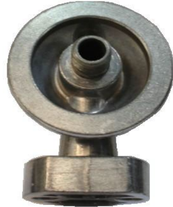
302-0701 SOPORTE FILTRO DE ACEITE Aplicación: Motores perkins 3-152, 4-203, 6-305 PF Utiliza unidad sellada Para invertir la posición del soporte, utiliza acople inversor 302-0705
