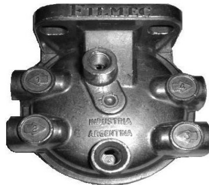
301-0501/1 TAPA FILTRO COMBUSTIBLE SIMPLE PERKINS REFORMA PARA UNIDAD SELLADA. ROSCA DEL ELEMENTO FILTRANTE 16 x 1,5 Roscas de Entrada / Salida 1/2-20
